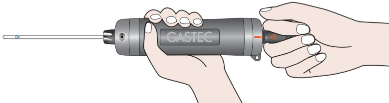
Şekil 15. Kırmızı kılavuz çizgisini gereken örnek hacmine göre ▲50 veya ▲100 ile hizalayın.
