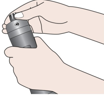
Şekil 8. Sızdırmazlık kontrolü 1. adım: giriş sıkıştırma somununun sıkılığını doğrulayın.
