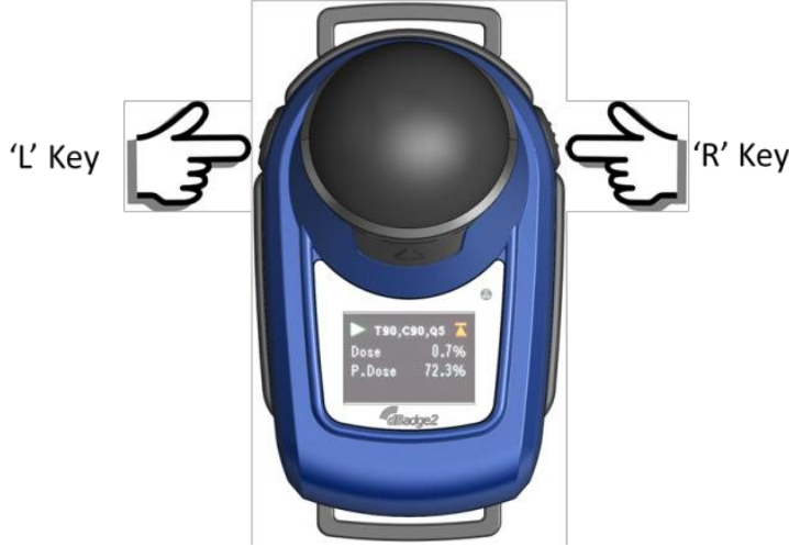
Şekil 7. Koşuyu başlatmak/durdurmak için iki tuşun birlikte kullanılması.
