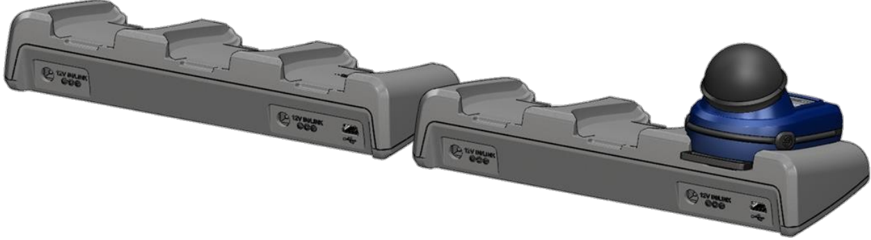
Şekil 5. Birden fazla docking station'ın bağlanmasına örnek.
