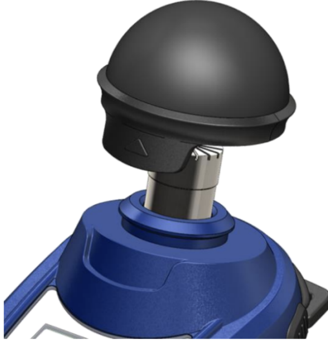
Şekil 10. Rüzgarlığın doğru çıkarma ve takma yönü. Klik sesi emniyetli oturmayı gösterir.
