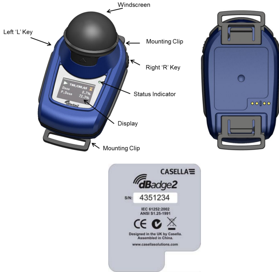
Şekil 11. Kullanıcı tarafından sağlanan bileşen diyagramı: sol/sağ tuş, rüzgarlık, montaj klipsi, ekran, durum göstergesi ve arka etiket.
