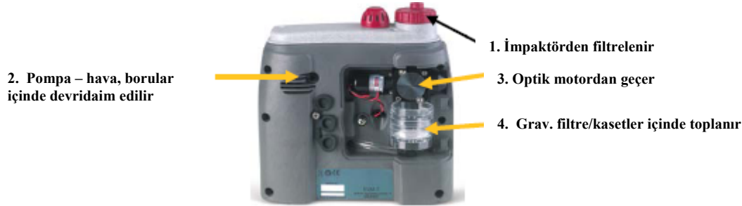
Şekil 4-3: İmpaktörün çalışma şekli
