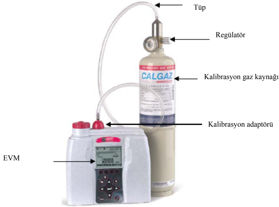
Şekil 4-17: Gaz sensörü uygulaması
